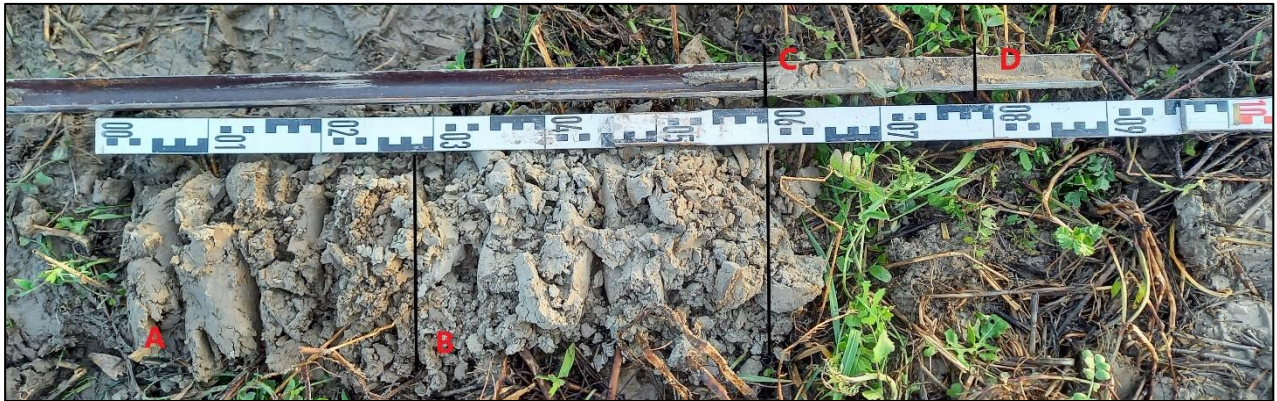
Afbeelding 19. Foto van boring 1 met daarop de bouwvoor (A), een grijze, sterk zandige wadafzetting (B), een grijze, licht kleiige wadafzetting (C) en een bruine, sterk zandige wadafzetting (D)
