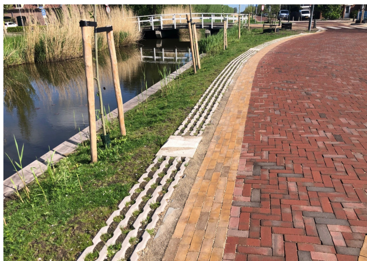
Afbeelding 35: referentiebeeld van bestrating van de woonstraten in dichte klinkers met aan weerszijden grasklinkers (totaal 5m breed)
