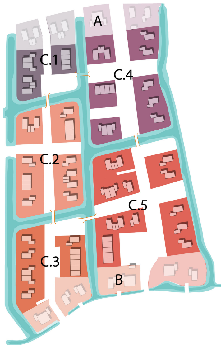
Afbeelding 17: samenhang per eiland wordt gevormd door voorgeschreven kleurenrange van de metselstenen
