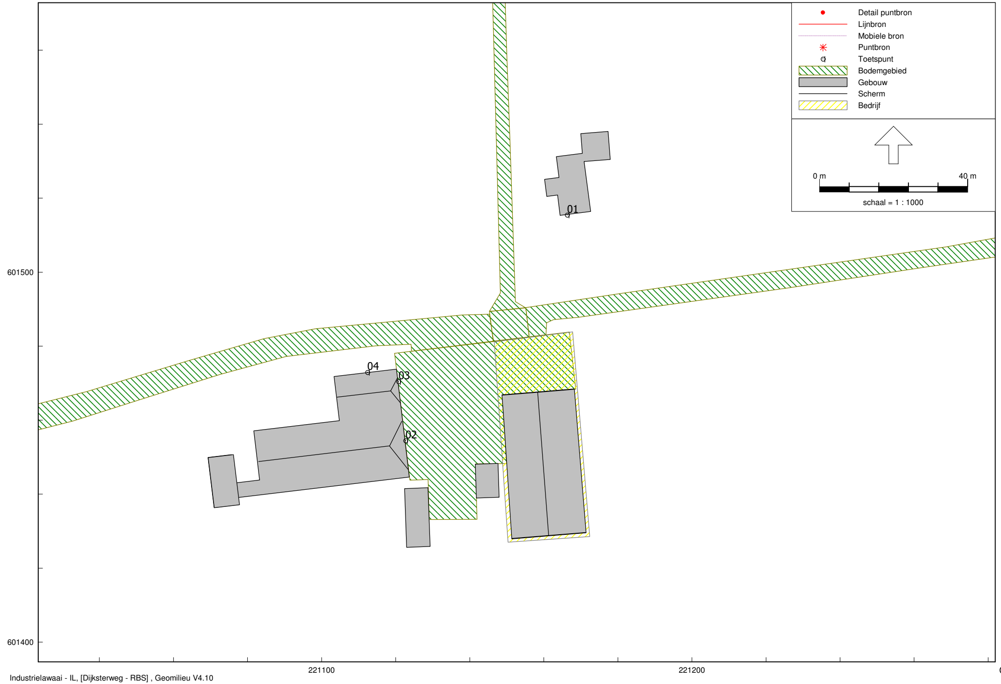
Overzicht van het rekenmodel, met de ligging van de ingevoerde objecten, bodemvlakken en rekenpunten
