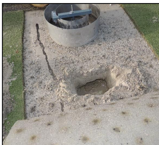
9. Infiltrometerproef op zandonderbouw locatie 2
