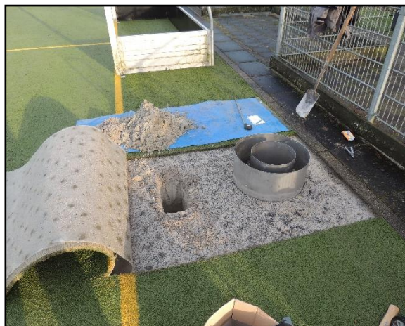
8. Infiltrometerproef op zandonderbouw locatie 1
