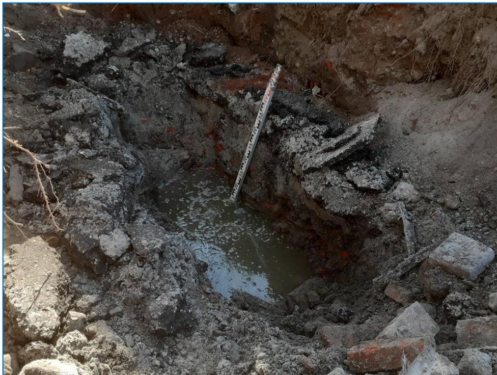
foto 6. Gatenonderzoek. Na uitvoering snel vollopende gaten.
