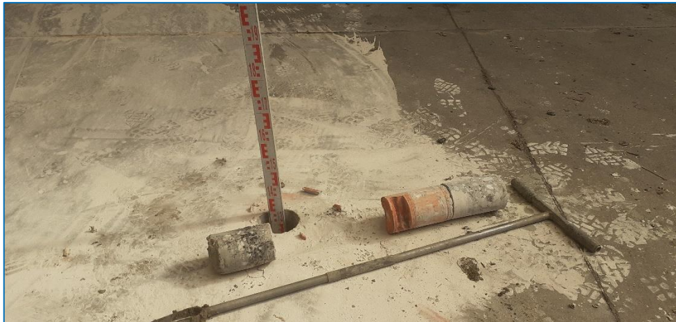
foto 7. Inpandige boring Y (holle ruimte aanwezig, zie ook naastliggende en richtinggevende boorstand)
