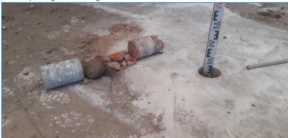
foto 5. Inpandige betonboring Z
