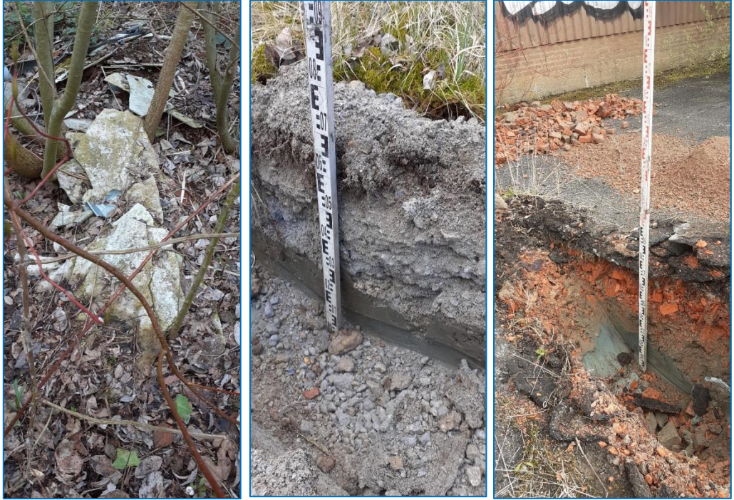
foto 1. AVM op maaiveld (links), slakken bij gat 11 (midden) en rood baksteenpuin onder asfalt (rechts)
