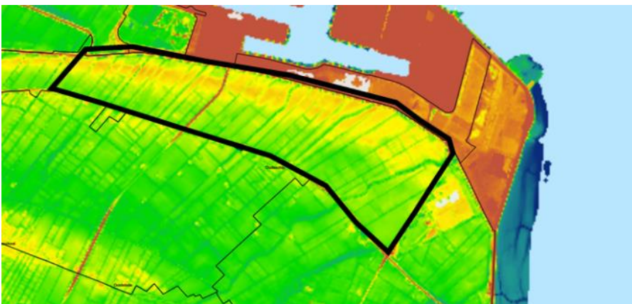
Figuur 2-2 Hoogte maaiveld volgens het Actueel Hoogtebestand Nederland (AHN). Langs de zuidelijke rand van het projectgebied heeft het maaiveld een hoogte van 1,25m+NAP (lichtgroen) en aan de noordzijde liggen delen op 2,00m+NAP (geel/oranje).
