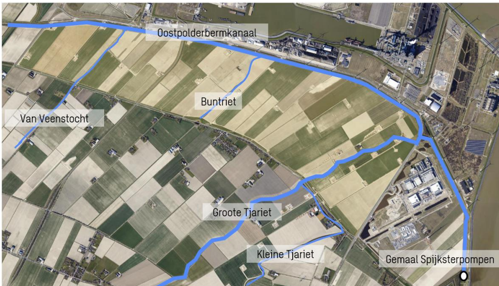
Figuur 2-1 Schematische weergave oppervlaktewatersysteem rondom de gebiedsontwikkeling Oostpolder. In lichtgeel het voorziene plangebied
