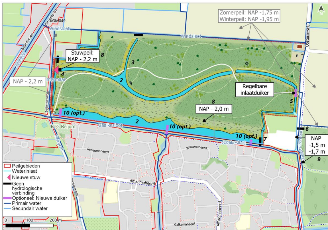
Afbeelding 4.5 Waterhuishoudkundige kaart: schematisch overzicht van de aanpassingen (in zwart) in het watersysteem. In grijs de huidige bestaande peilen voor het complete overzicht
